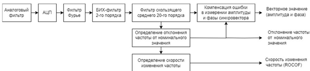
Рис. 3. Структурная схема алгоритма обработки входного сигнала в УСВИ Р-класса
